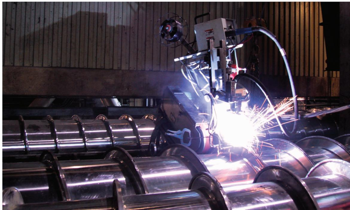
Les presses à double vis en fonctionnement sont soumises à l'usure et à l'abrasion. Le dégagement entre le sommet des hélices et les plaques perforées a une influence sur la performance de la presse. C'est la zone qui est la plus exposée à l'usure et à l'abrasion. Par conséquent, après un certain temps la performance diminue et les hélices doivent être rechargées pour retrouver leur diamètre original.
